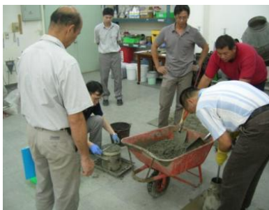
混凝土試拌：空氣含量、坍度試驗
